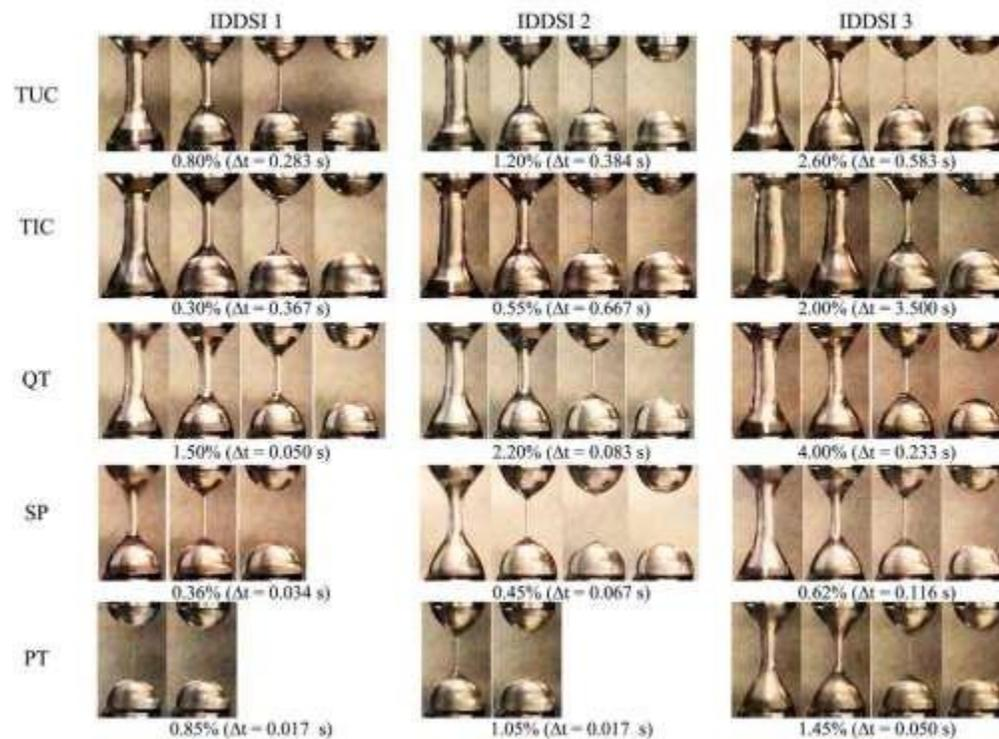
Illustration de l'amincissement par extension des liquides épaissis à différents niveaux de l'IDDSI :  $\Delta t$  est la différence de temps entre la frappe et la rupture du filament de l'échantillon. Reproduit à partir de "On the assessment of shear and extensional rheology of thickened liquids from commercial gum-based thickeners used in dysphagia management", par Kongjaroen, A. et al., 2022, *Journal of Food Engineering*, 316, p. 6.
