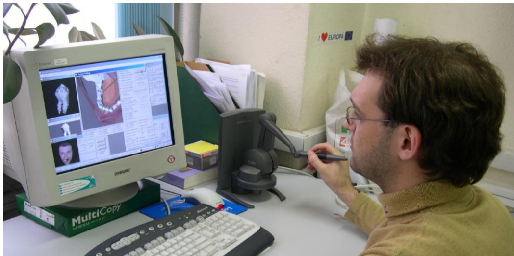
Figure 9. Simulateur numérique composé du logiciel informatique accompagné du détecteur optique et du système électromécanique 33 .
