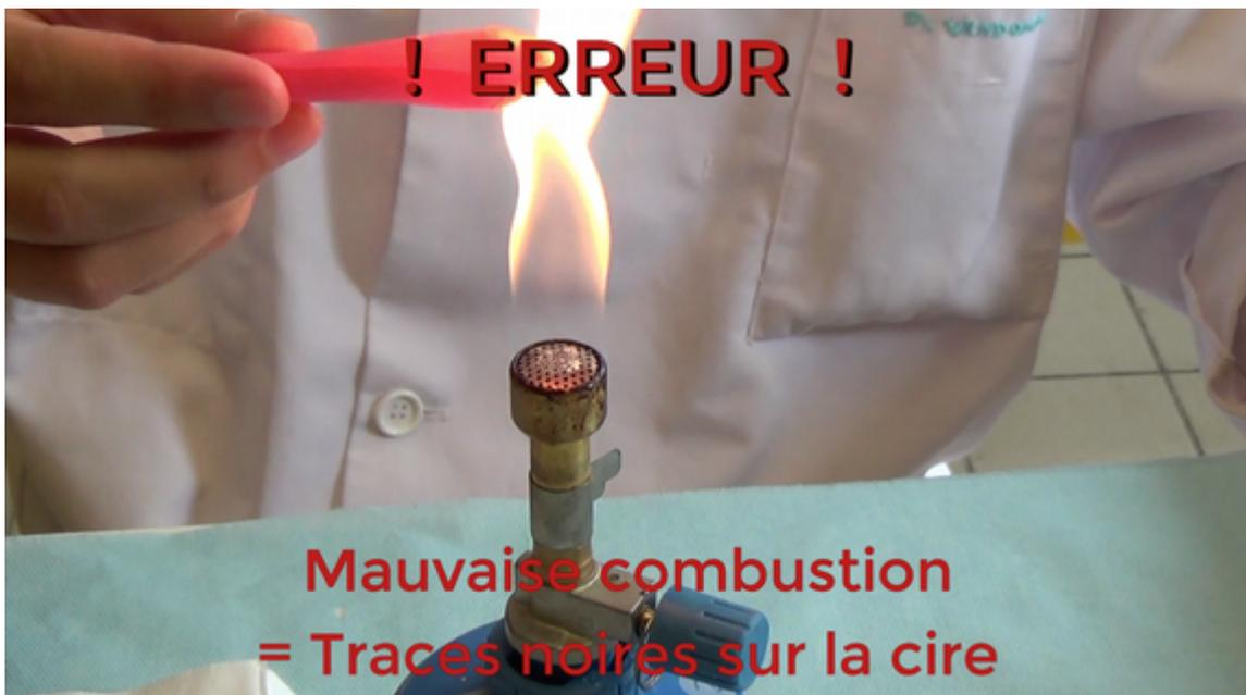
*Figure 11 : capture de la vidéo sur la mauvaise combustion du Labogaz®*
