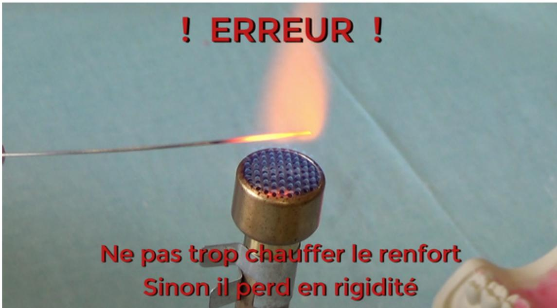
*Figure 10 : capture de la vidéo sur le chauffage excessif du renfort*
