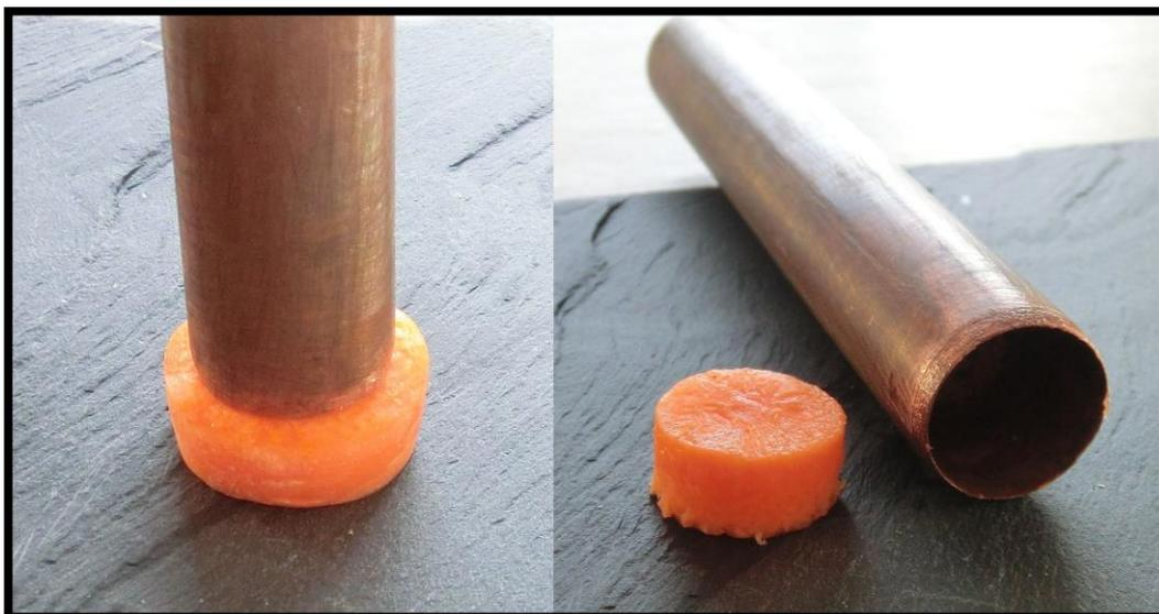
Figure 2 : Préparation de l'échantillon de carotte avec l'emporte-pièce
