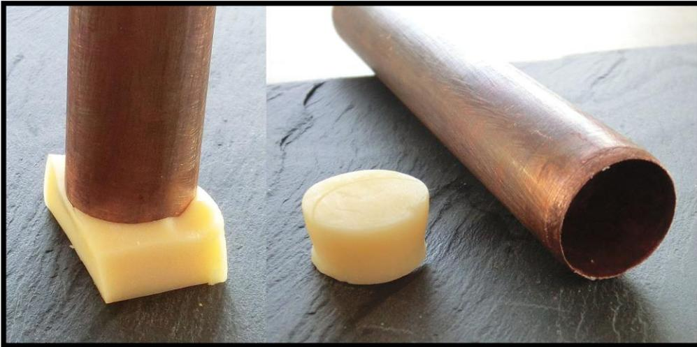
Figure 4 : Préparation de l'échantillon fromage avec l'emporte-pièce
