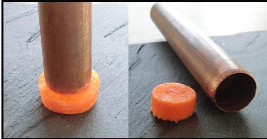
Figure 2 : Préparation de l'échantillon carotte avec l'emporte-pièce
