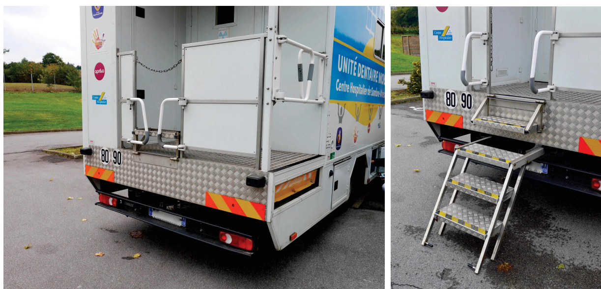
Figure 8 : Escalier emprunté par le personnel soignant, replié et déployé
