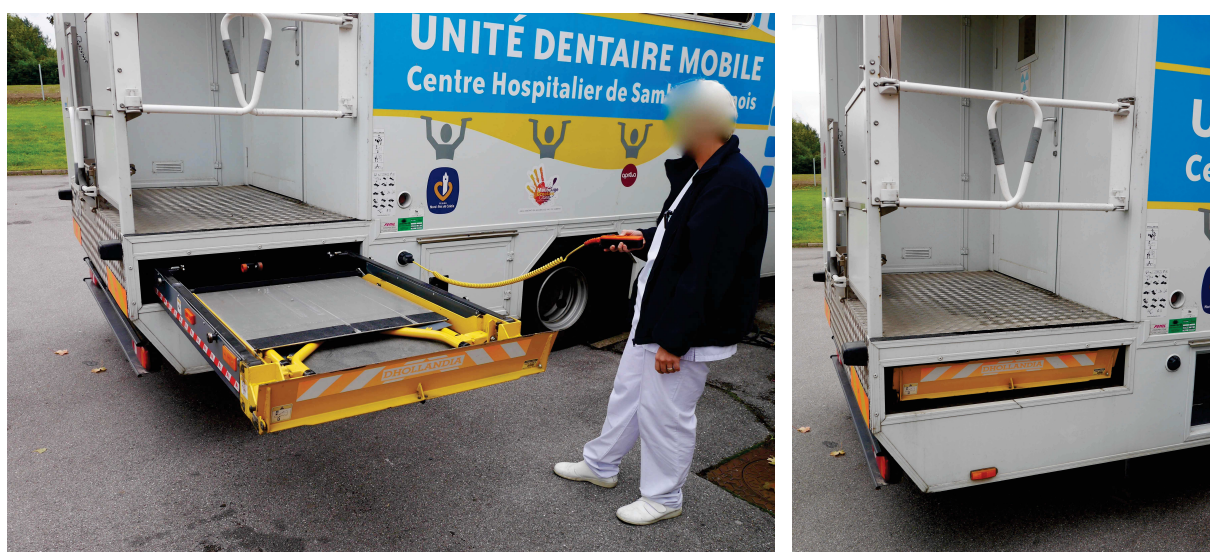
Figure 36 : Rangement du hayon élévateur dans son compartiment situé sous le plancher du véhicule, avant déplacement routier de l'unité dentaire mobile
