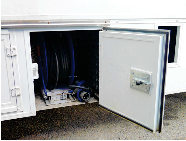
Figure 13 : Dispositif d'alimentation électrique externe : compartiment et enrouleur
