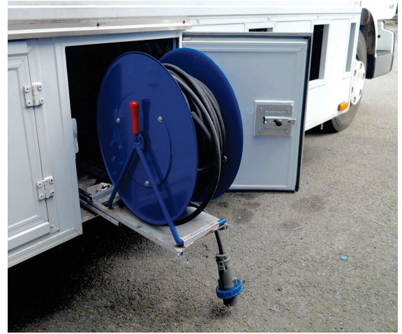
Figure 13 : Dispositif d'alimentation électrique externe : compartiment et enrouleur
