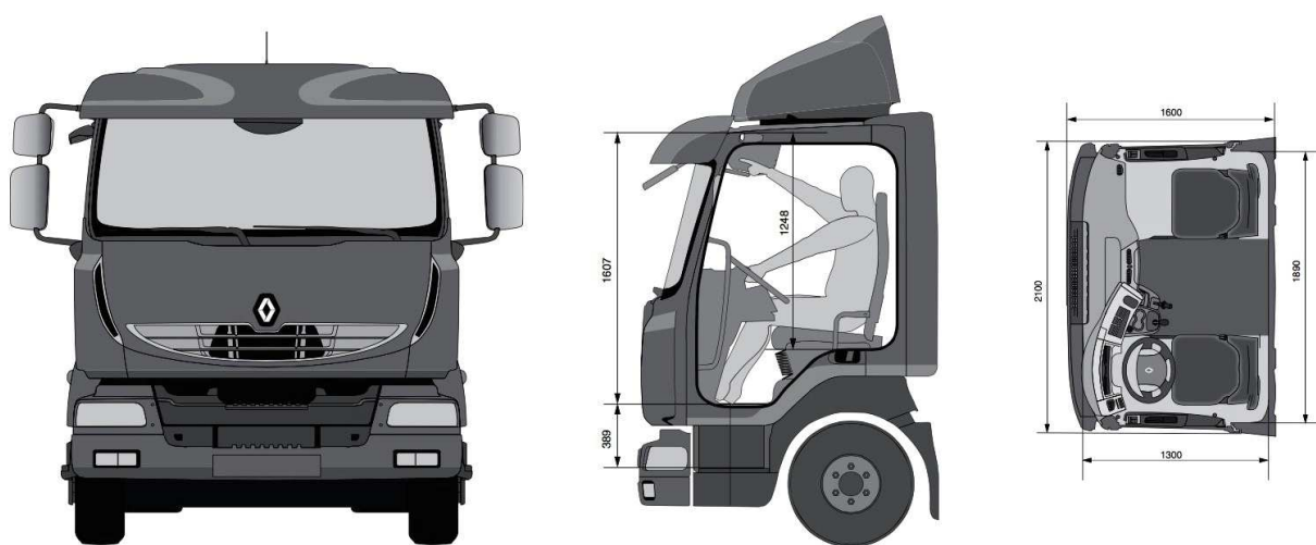
Figure 5 : Schéma de la cabine courte du Renault Midlum
