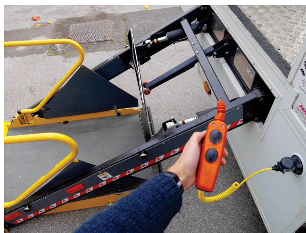
Figure 9 : Détails du hayon : plateau, bras de levage, vérins et boîtier de commande
