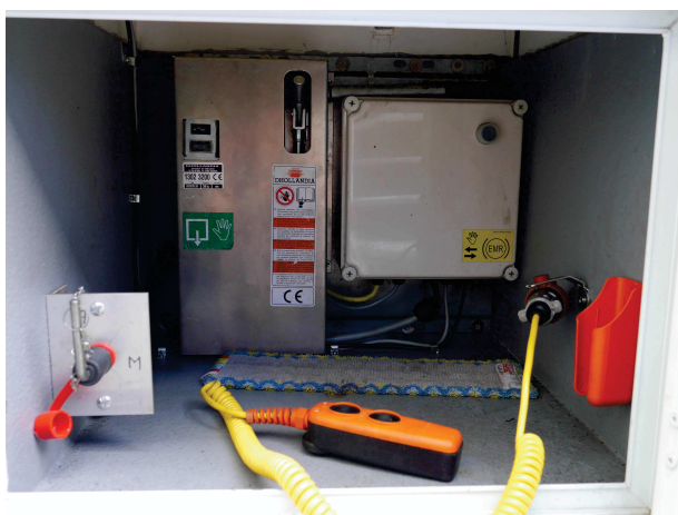
Figure 10 : Groupe hydraulique en coffre actionnant le hayon
