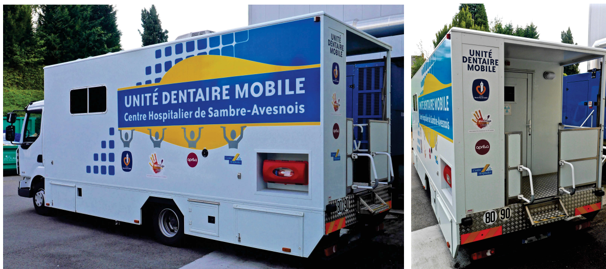
Figure 7 : Carrosserie de l'unité dentaire mobile : caisse autoportante et plateforme d'accès
