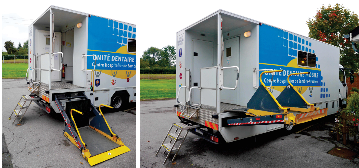
Figure 11 : Hayon élévateur permettant l'accès aux résidents : en position basse, puis haute
