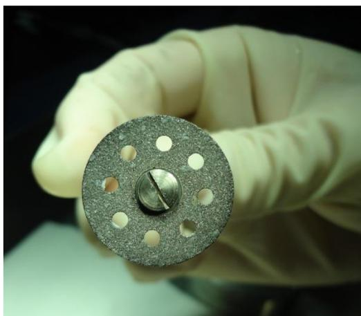
Figure 44 : disque diamanté perforé pour meulage du bloc ostéo-dentaire
