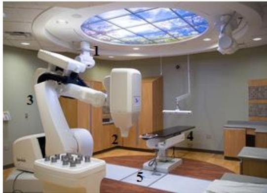
*Figure 12 : Equipement de Cyberknife®. 1. Tube à rayon X pour radios de vérification du repositionnement en cours de traitement, 2. Accélérateur miniaturisé, 3. Robot, 4. Table robotisée, 5. Détecteurs couplés aux tubes à rayons X (34).*
