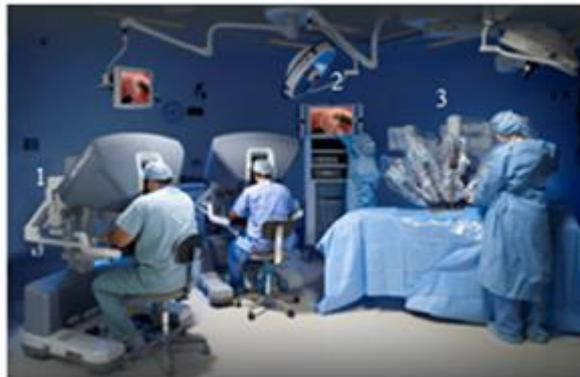
*Figure 7 : Configuration de la salle de bloc opératoire pour la réalisation d'une chirurgie trans-orale à l'aide du robot chirurgical da Vinci Si® (2009) Intuitive Surgical, Inc da Vinci. 1. console de commande, 2. colonne technique, 3. bras articulés (18).*
