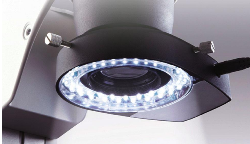
Figure 7 : exemple d'éclairage LED sur le MO *
