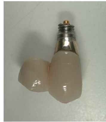
Figure 68 : Vue de la fracture de l'implant après dépose de celui-ci. L'implant Branemark Mark II de Nobel Biocare (diamètre 3,75mm et 18mm a été posé il y a 2 ans) d'après K. Gibney (75) p616
