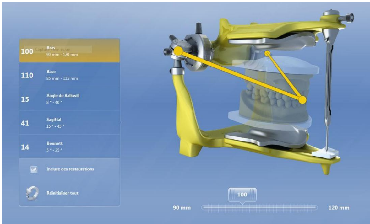
Figure 18 – Fenêtre "Paramètres d'articulation" du logiciel Cerec® 4.2. La modification des différents paramètres permet de programmer l'articulateur virtuel. Crédit : Sirona.
