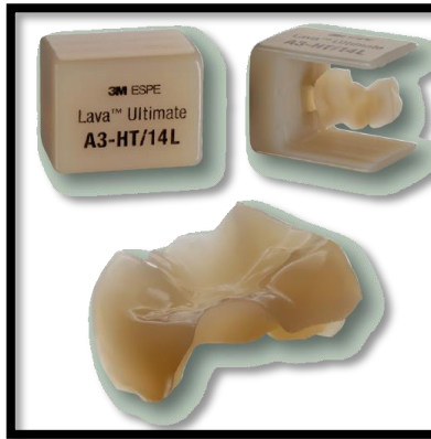
Figure 10 : Lava-Ultimate® (3M ESPE) avant, pendant et après l'usinage de l'inlay-onlay par CFAO
