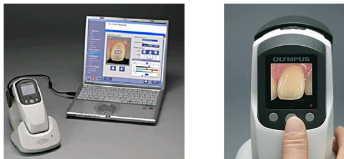
Figure 17: le spectrophotomètre CrystalEye de Olympus qui prend la photo directement en bouche (23)
