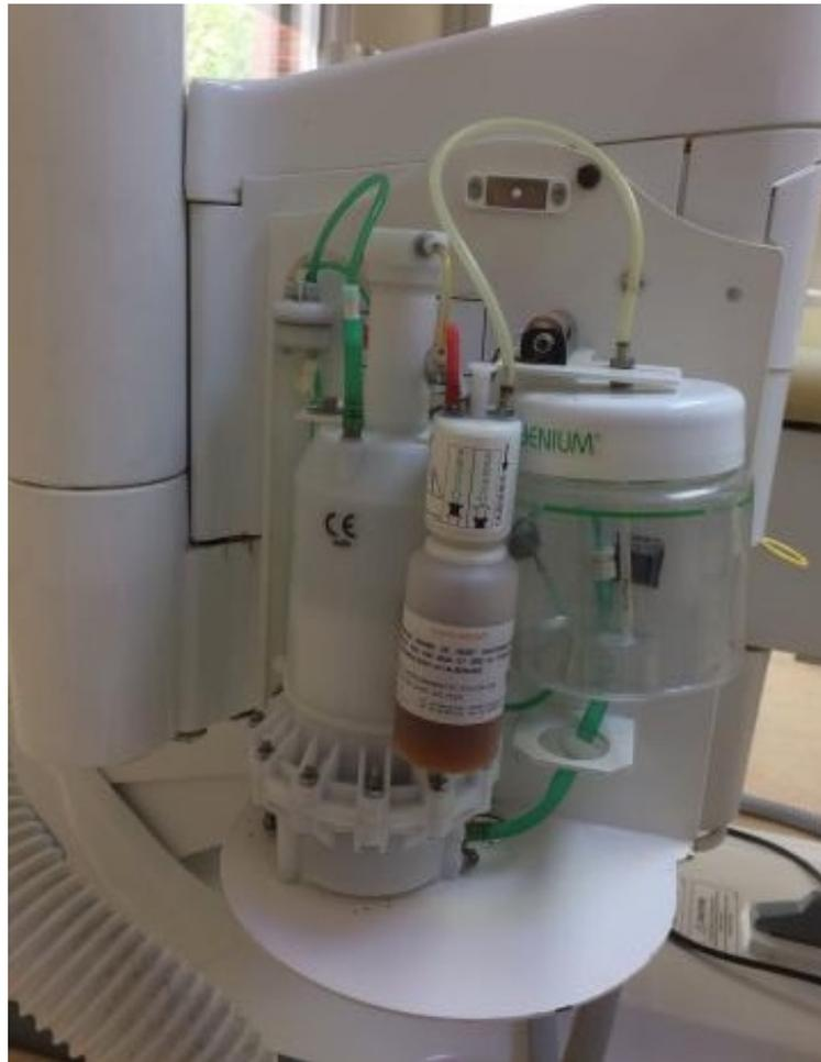
**Figure 9** : Système IGN avec le réservoir de solution de Calbenium® (Courtoisie du Dr T Marquillier)
