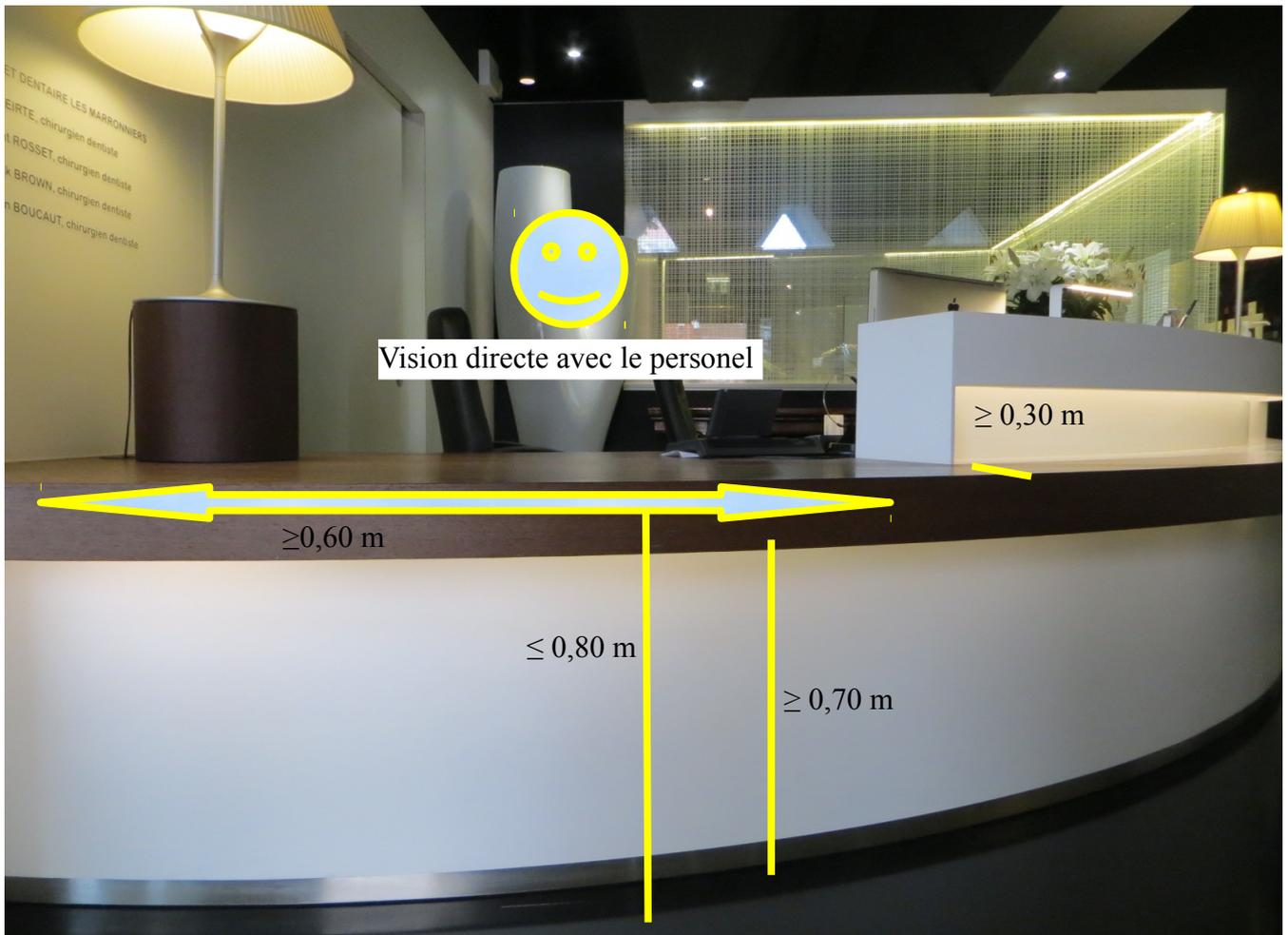
Figure 21: Aménagement adaptée à hauteur de la personne circulant en fauteuil [photo prise par l'auteur]
