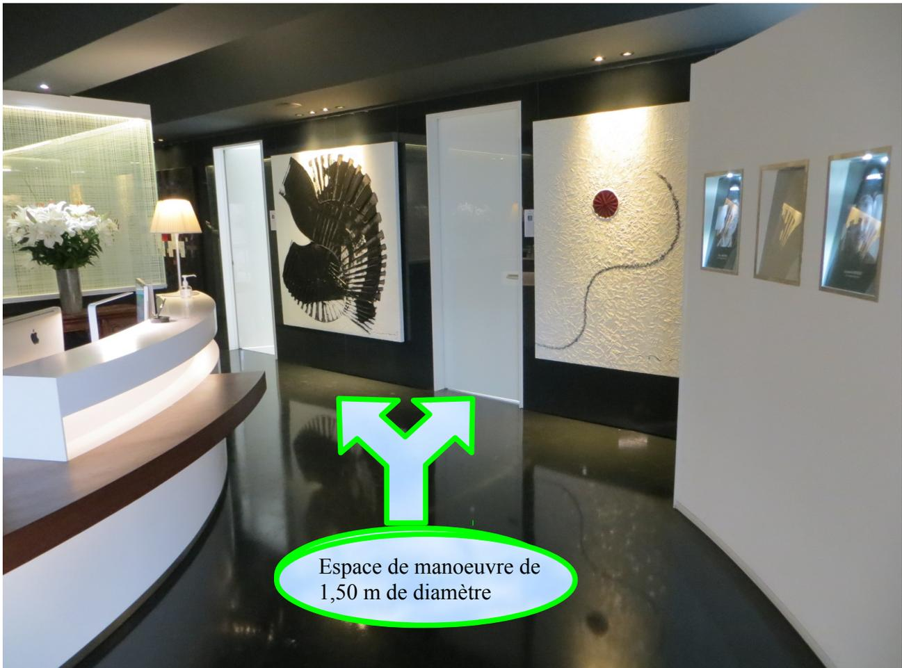
*Figure 20: Hall d'entrée spacieux avec un espace de manoeuvre important offrant aux personnes en fauteuil un cheminement aisé [photo prise par l'auteur]*
