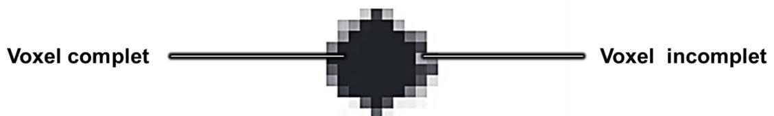
Figure 14 : image en coupe acquise par  $\mu$ -CT d'un canal instrumenté. Les voxels complets (noirs) ont été considérés comme des zones instrumentées tandis que les voxels incomplets (gris) ont été considérés comme des zones non instrumentées.
