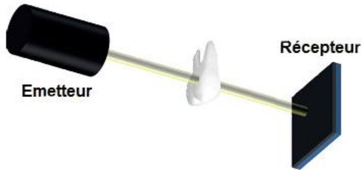
Figure 67 : schéma représentant le fonctionnement de la radiographie conventionnelle [99]
