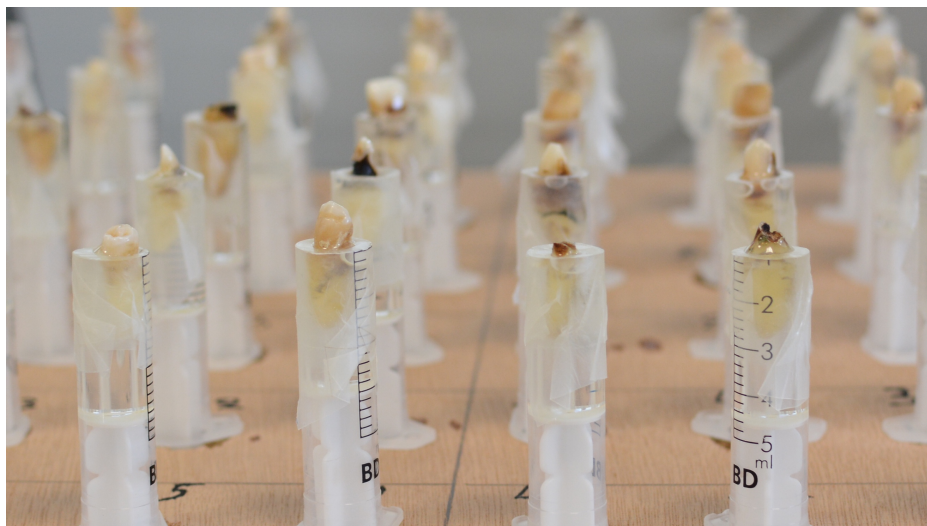
Figure 14 : Positionnement des dents avec leur grand axe parallèle à la seringue.
