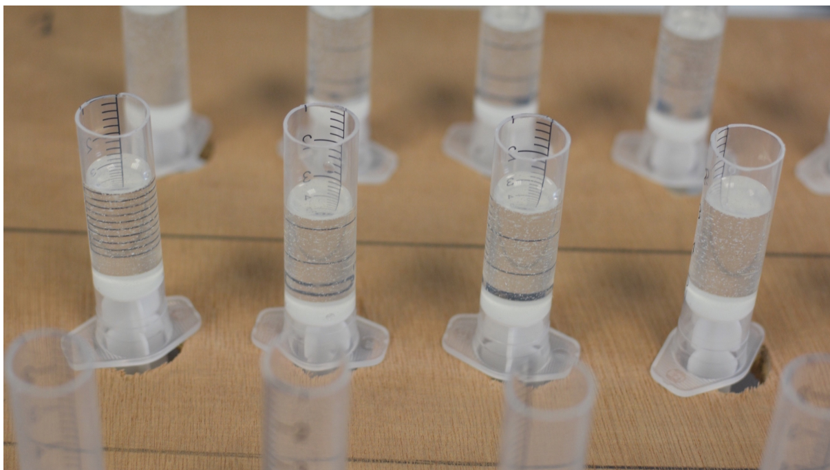
Figure 13 : Répartition de la résine d'inclusion dans les seringues (environ 3ml par seringue).
