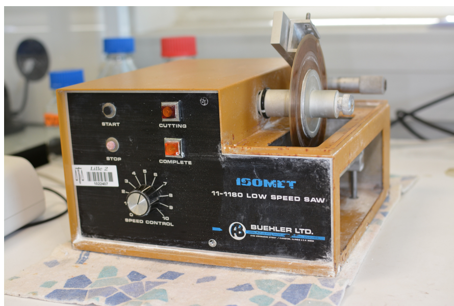
Figure 15 : Scie diamantée à vitesse lente Isomet® Buehler®.
