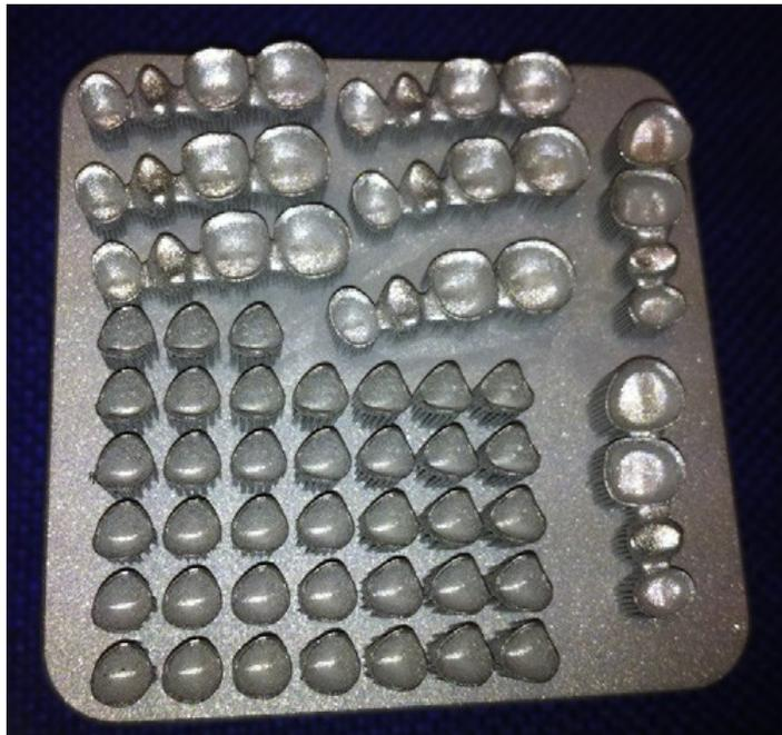
*Figure 2 : Couronnes et infrastructures métalliques mises en forme par SLM <sup>[10]</sup>.*
