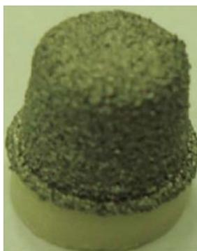
*Figure 3 : Infrastructure de couronne unitaire réalisée par EBM <sup>[26]</sup>.*
