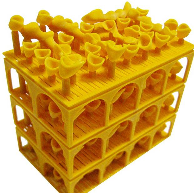
Figure 18 : Infrastructures de prothèses fixées en résine calcinable réalisées par SLA [10].
