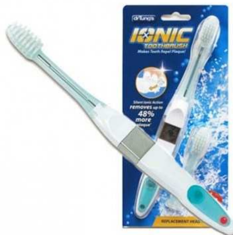
Figure 10 : Brosse à dents ionique : un courant électrique est appliqué aux filaments pendant le brossage des dents qui inverse la polarité et attire la plaque vers le filament. Pas de mouvement automatisé (37)
