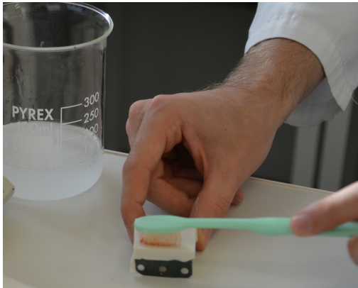
Illustration 13 : Application de la solution de carbonate de sodium à la brosse à dents (Photo de l'auteur)
