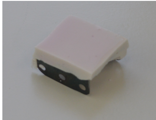
Illustration 14 : L'alginate présente une teinte rosée après l'application du carbonate de sodium (Photo de l'auteur)
