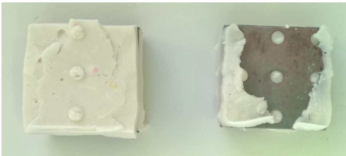
Illustration 23 : Rupture cohésive lors du test avec application de carbonate de sodium à 0,7% (Photo de l'auteur)
