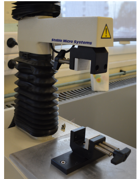
Illustration 7 : Mâchoires fixées sur la machine de traction (Photo de l'auteur)
