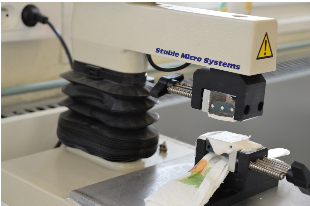
Illustration 18 : Fin du test de traction les 2 couches d'alginate sont séparées (Photo de l'auteur)
