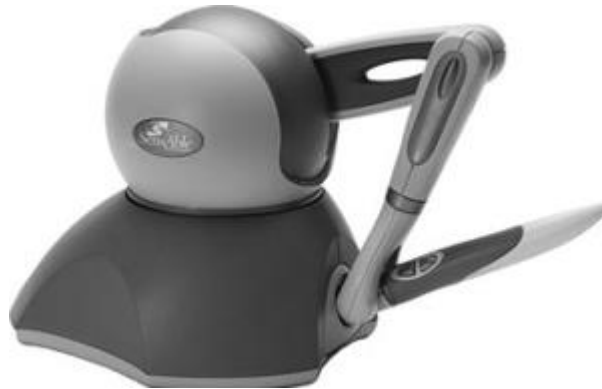
Figure 17: Bras haptique avec retour de force (modèle SensAble Omni Haptic Simulator®)
