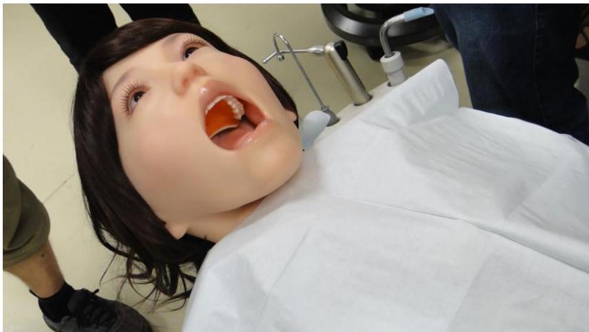
Figure 13: Hanako 2: la robotique au service de la simulation en chirurgie dentaire
