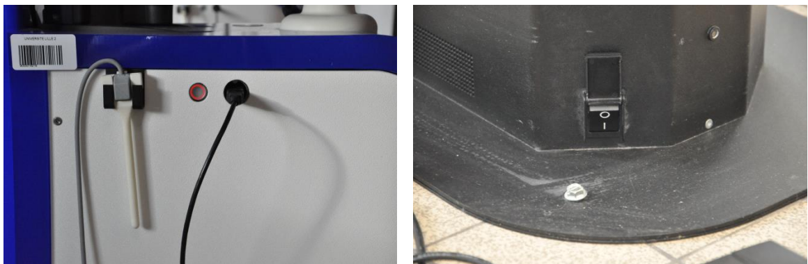
Figure 30: De gauche à droite : dispositif secondaire, bouton de démarrage de l'unité centrale informatique, port USB et interrupteur de mise en tension du simulateur
