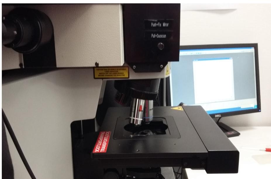
*Illustration 11: microscope intégré au spectromètre et réglé avec un zoom x100.*
