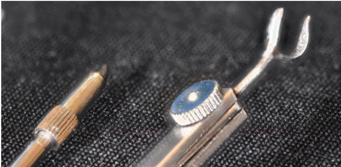
Figure 64 : Confection d'une griffe pour remplacer la pointe du compas (Docteur LEFEVRE)
