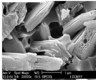
Figure 18: Cristaux imbriqués de la céramique en disilicate de lithium [40].
