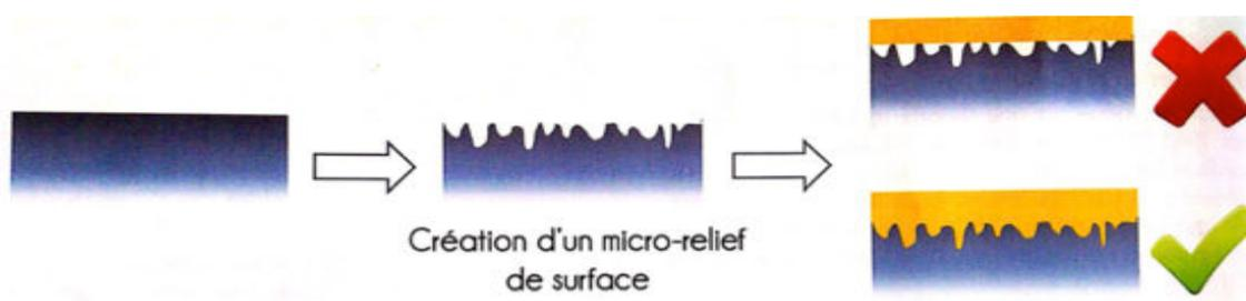
*Figure 8 Illustration de l'adhésion micromécanique. Une bonne adhésion nécessite la création d'un micro relief ainsi qu'une bonne infiltration au sein de ces aspérités [18].*
