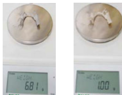
Figure 19 : Pesées des châssis mandibulaire en Chrome Cobalt à gauche et en PEEK à droite, B Picart et coll. (8).
