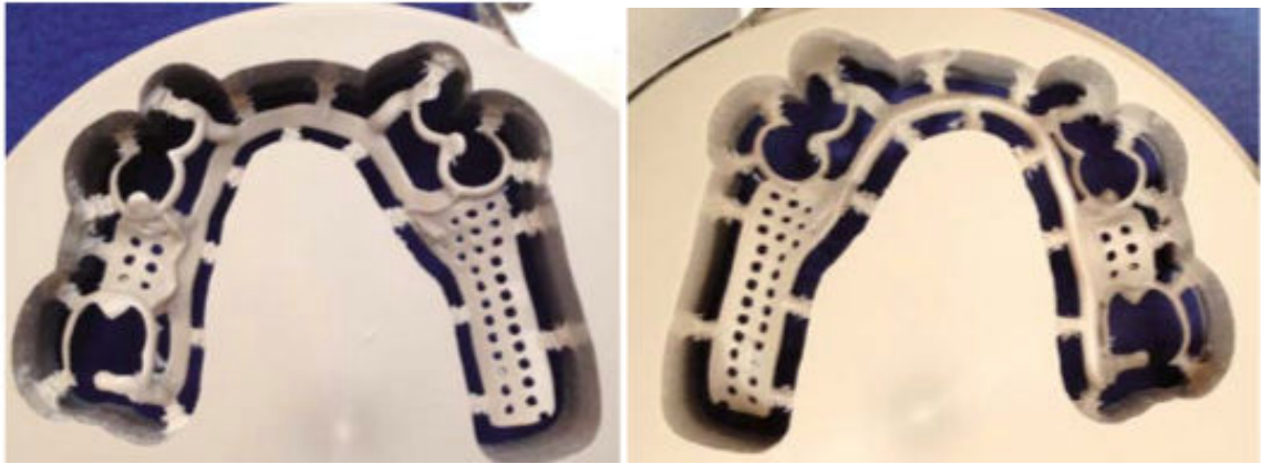
Figure 40 : Châssis mandibulaire usiné au sein du disque de PEEK, vue de dessus à gauche et vue de dessous à droite par B Picart et coll. (8).
