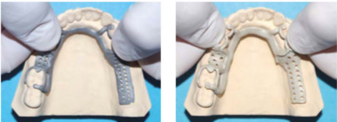
Figure 17 : Test de la désinsertion du châssis en Chrome Cobalt à gauche et du châssis épaissi en PEEK à droite, B Picart et coll. (8)
