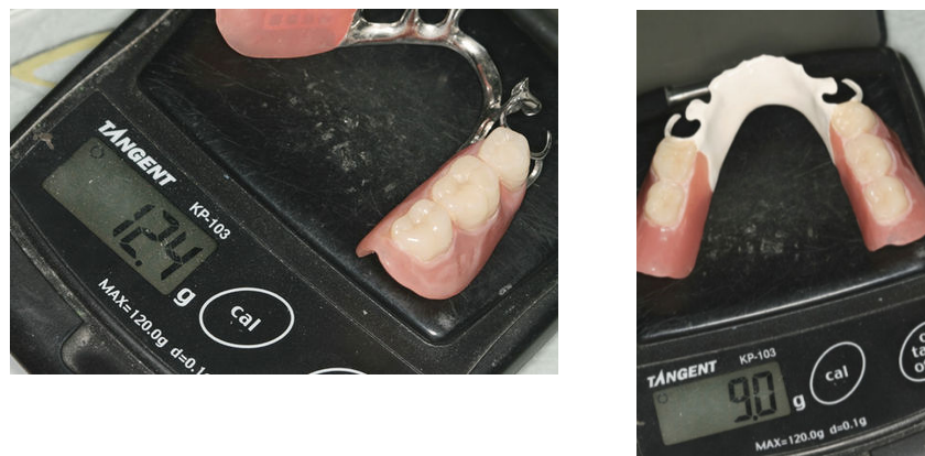
Figure 20 : Pesée comparative des châssis de prothèse amovible partielle en chrome cobalt et en BioHPP®, P Zoïdis (48).
