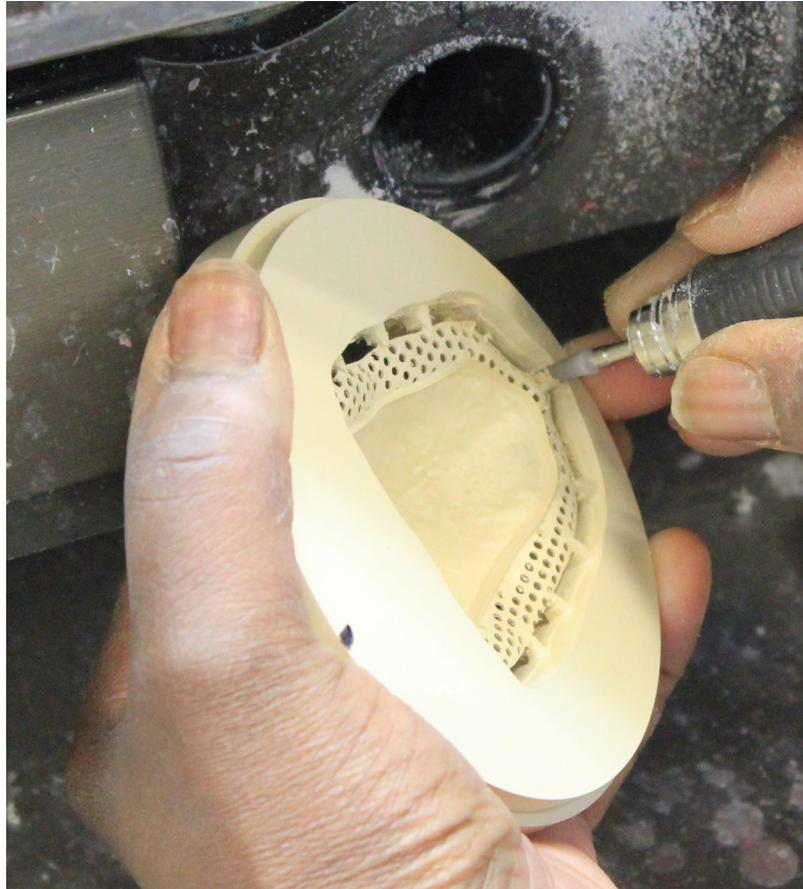
**Illustration n°34** : Photographie de la découpe des ergots de maintien reliant la plaque palatine en PEEK usinée à son disque
