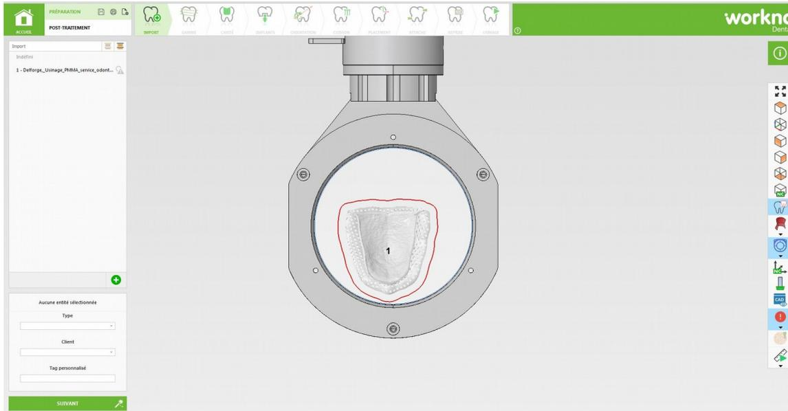
**Illustration n°27 : Positionnement de la plaque à usiner au sein du disque**
