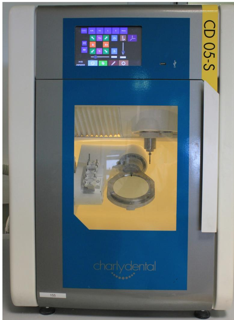
**Illustration n°30 : Photographie de l'usineuse CD-05S de chez Charly Dental® avec le disque de PEEK mis en place**
