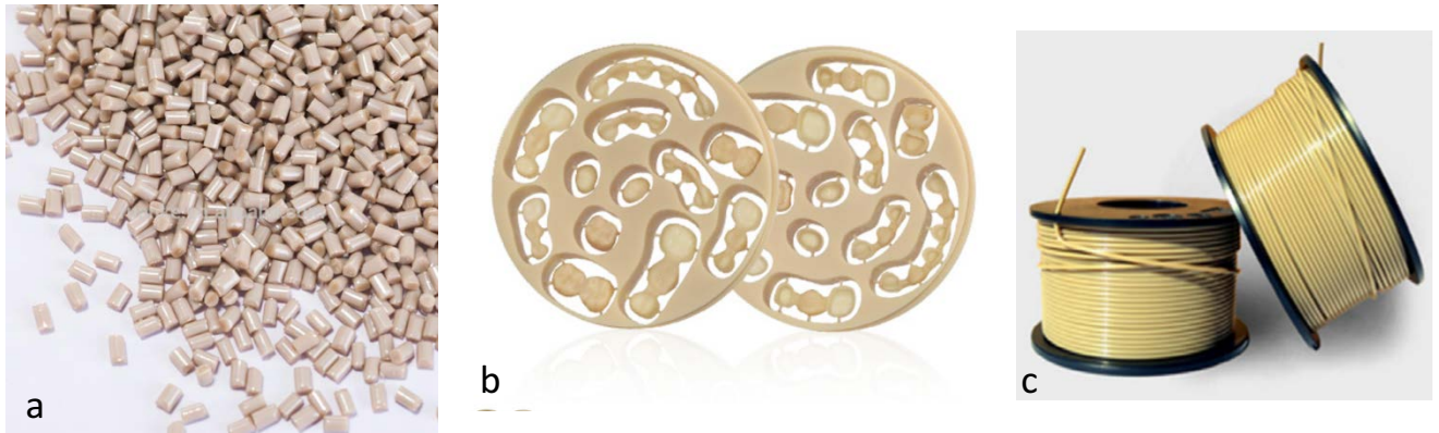
Figure 13 : les trois formes du PEEK a) sous forme de granulés [44] b) sous forme de disques usinables [45] c) sous forme de fil pour imprimante 3D [46]
