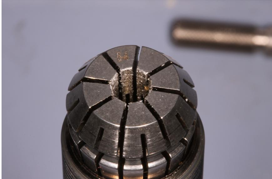
Stabilisation de la partie « dent » de l'échantillon pour les tests de traction :
