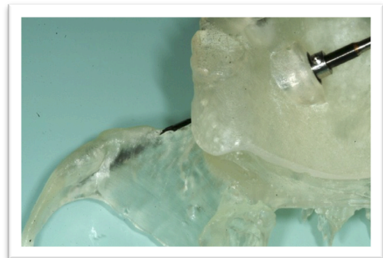
Figure 70 : Vérification des forages sur la maquette zygomatico-maxillaire produite par stéréolithographie [103]
