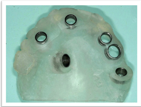
Figure 69 : Guide chirurgical personnalisé produit par stéréolithographie [103]
