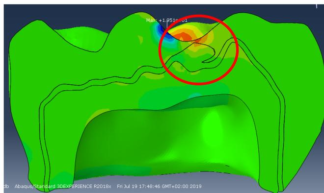
**Figure 29 : Mise en évidence d'un défaut de conception du liner lors de la modélisation sur CATIA**
