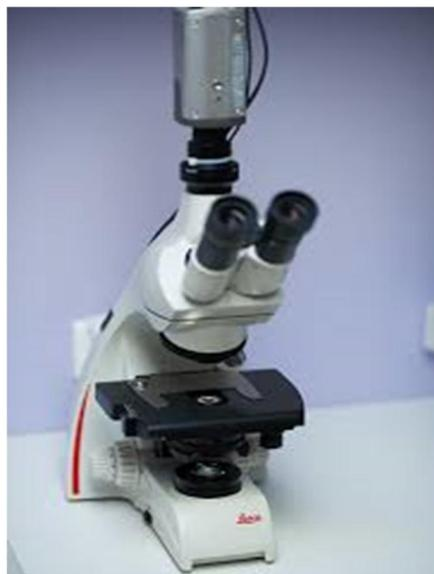
*Figure 17: microscope à contraste de phase (source internet)*
