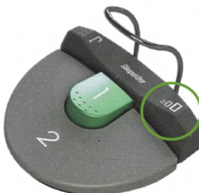
*Figure 21 : Pédale du SleeperOne® 5, indication du bouton de changement de mode d'injection (34).*
