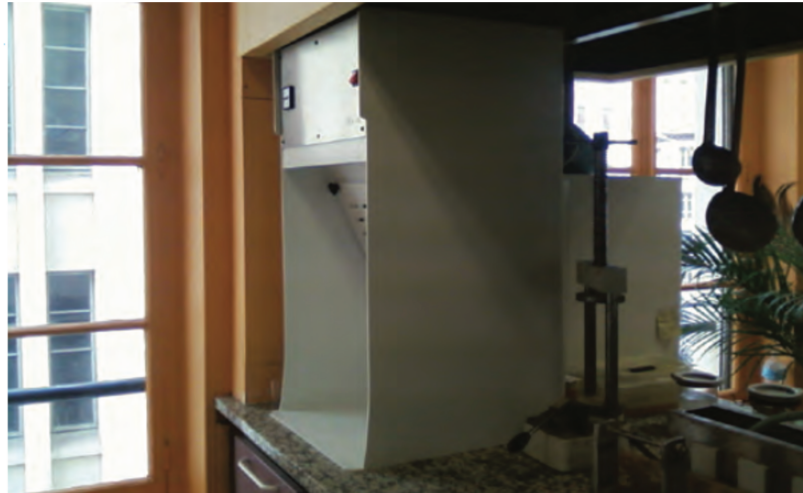
Figure 23 : Caisson utilisé pour la manipulation de la résine [17].
