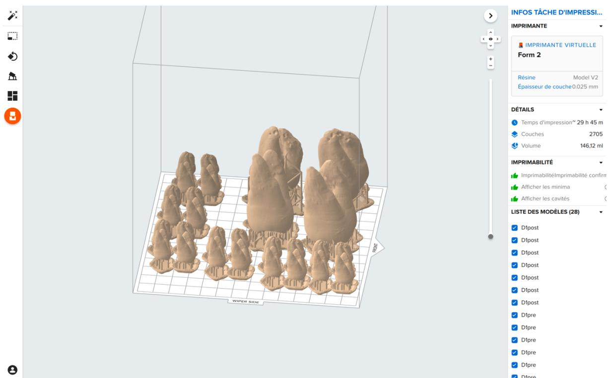
Figure 25 : Visualisation des modèles virtuels sur plateau sur le logiciel PreForm, FormLabs et paramètres d'impression
