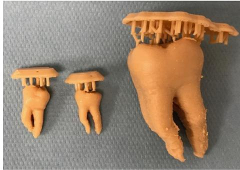
Figure 26 : Modèles pédagogiques en taille réelle et surdimensionnés sur socle (points de contacts 0,4 mm)
