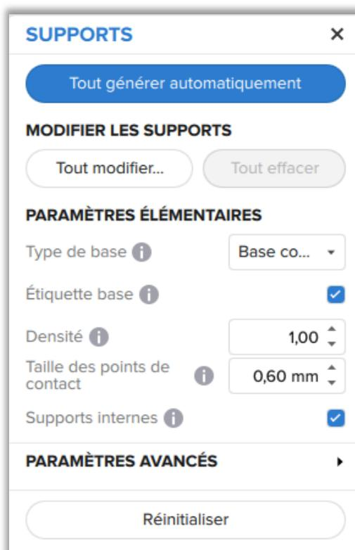
*Figure 50. Paramètres des supports d'impression sur le logiciel PreForm (Illustration personnelle)*
