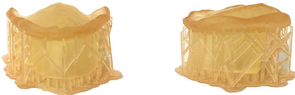
*Figure 53. Bases d'occlusion imprimées avec leurs supports d'impression (Photographie personnelle)*
