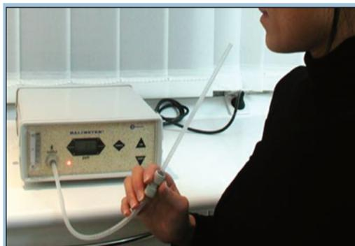
Figure 12 : Halimètre, système de chromatographie en phase gazeuse portable (47)
