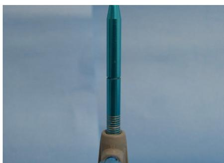
*Figure 91 - Augmenter la tige incisive (3-4 mm) en fonction de l'épaisseur de la cire*
