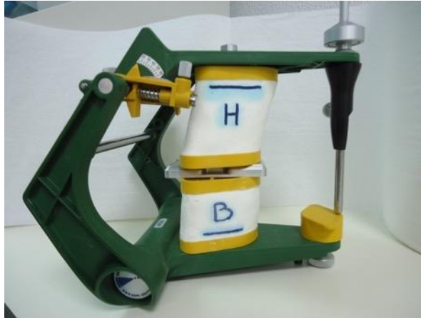
Figure 15 : montage de la pièce de calibrage au centre de l'articulateur physique SAM® (photographie Euromax Monaco®).
