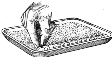
Figure 50 : schéma représentant la disposition des biscuits sur une plaque garnie de silex pulvérisés [29].
