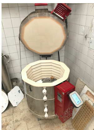
Figure 4 : photographie d'un four électrique à céramique dans l'atelier de Camille Fourmaintraux à Wimereux [iconographie personnelle].
