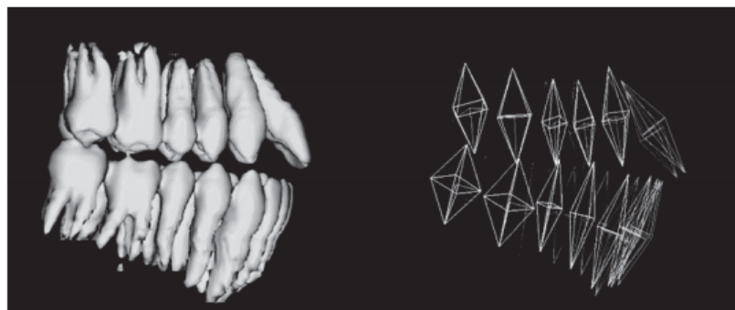
Fig. 9 : Reconstruction et matrices d'inertie des différentes dents d'une arcade
