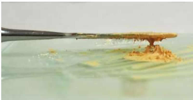
Figure 25 : ciment de scellement à la bonne consistance
