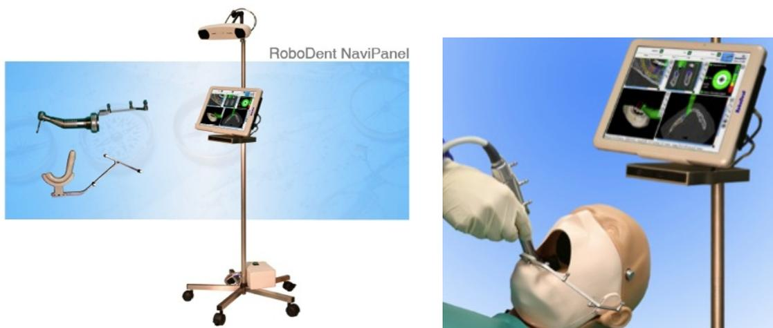
*Figure 11* : Photographie du système RoboDent (27)(28)
