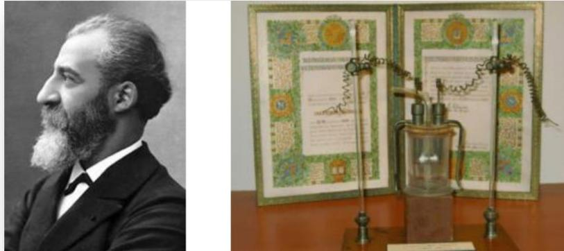
Figure 2 : Henri Moissan et l'électrolyseur ayant servi à isoler le fluor (12)
