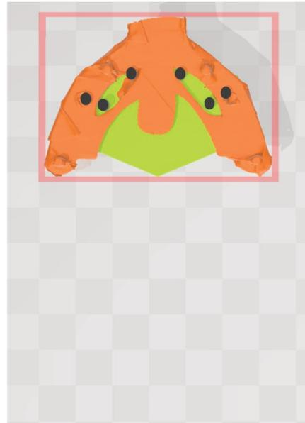
Figure 29: scan du gnathomètre servant de gabarit à la conception du porte-gnathomètre, sur le logiciel 3DBuilder (illustration personnelle)
