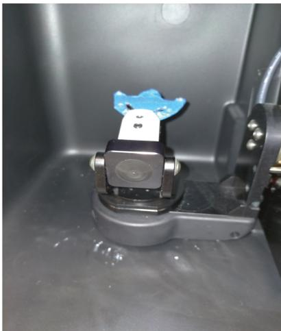
*Figure 25: gnathomètre maxillaire, entouré d'un adhésif mat pour faciliter la prise de vue, puis fixé sur le bras de préhension sur son support dans le scanner DentalWings7 (illustration personnelle)*
