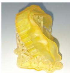
Figure 55 : vue du PEI mandibulaire en sortie d'imprimante après photopolymérisation et trempage dans un bain d'alcool (illustration personnelle)
