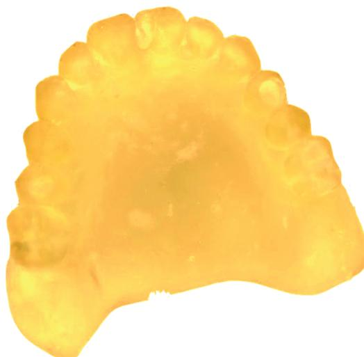
*Figure 23: maquette avec relief cuspidien imprimé en résine par imprimante laser Formlabs (illustration personnelle)*
