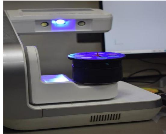
Figure 40 - Scannage de l'inlay-core grâce au scanner extra-oral de laboratoire [104].
