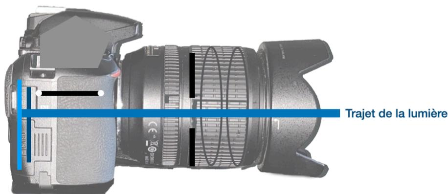
**Figure 21** : schématisation d'un appareil photo reflex lors du déclenchement
