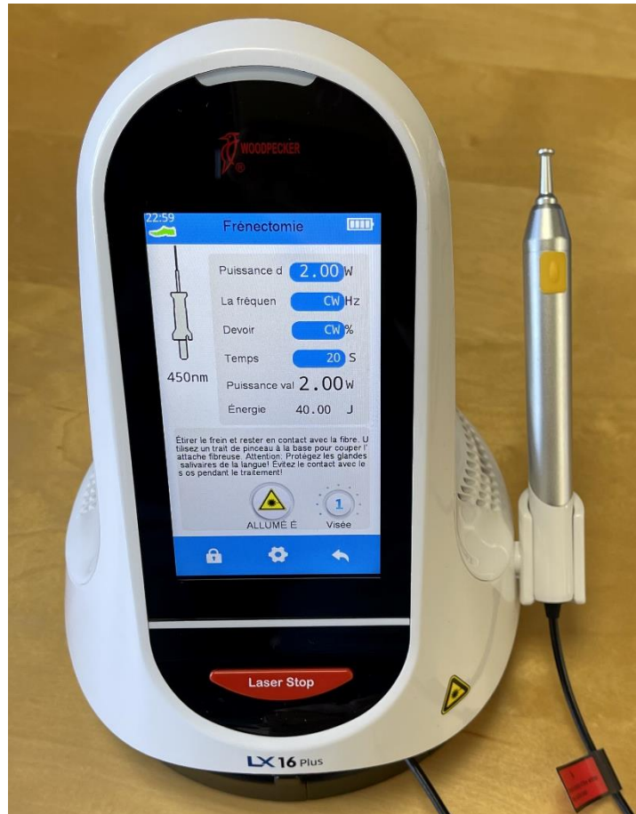
Figure 14: écran de réglage du LASER diode LX 16 de Woodpecker® (illustration personnelle)
