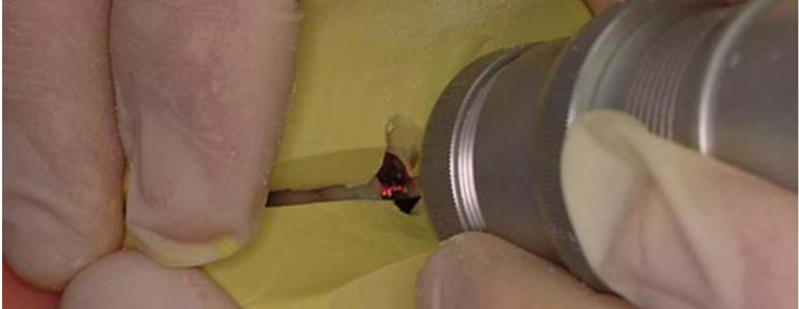
Figure 42: photographie de la soudure au LASER Nd:YAG du bridge [61]
