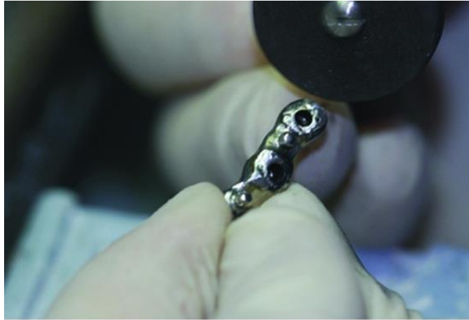
Figure 39: photographie du meulage et polissage de la barre après soudure [62]
