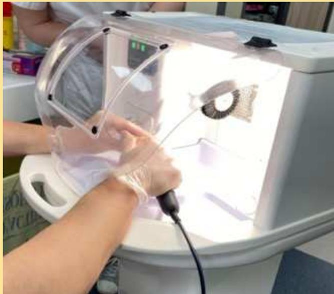
Figure 152 : dépolissage de l'intrados à la fraise résine [source personnelle]
